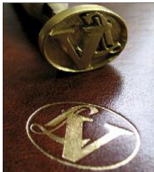
Un fer à dorer est un outil typographique (les pleins de la matière gravée servant de surface de marquage), façonné dans du laiton ou du bronze, permettant de marquer à chaud par pression (dorure à chaud manuelle ou mécanique) différents supports en intercalant, entre l'objet à marquer et cet outil, un film « transfert » de couleur métallique ou bien une véritable feuille d'or battu.
